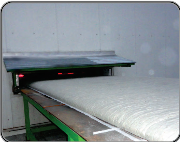
Bis zu 15 cm hohe Endlos-Schaumglasplatten kommen aus dem Ofen
